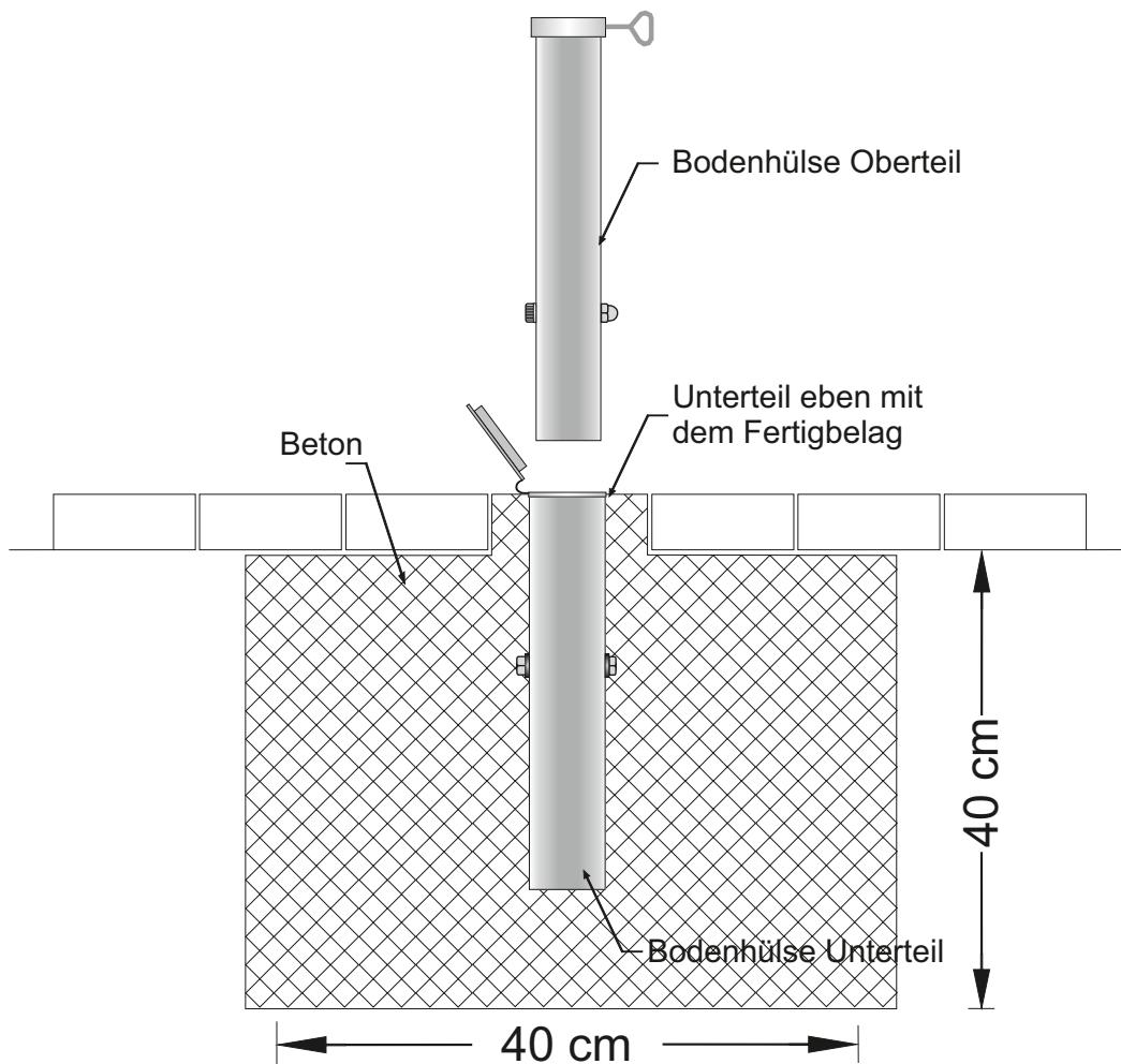
Die Abmessungen des Fundaments sollten die angegebenen Abmessungen nicht unterschreiten. Das Unterteil der 2-teiligen Bodenhülse soll bündig mit dem Fertigbelag abschließen. Der Standort der Hülse ist so zu wählen, dass bei offenem Schirm der Abstand zu Gebäuden, sonstigen Gegenständen, sowie weiteren Schirmen ca. 20 cm beträgt.
